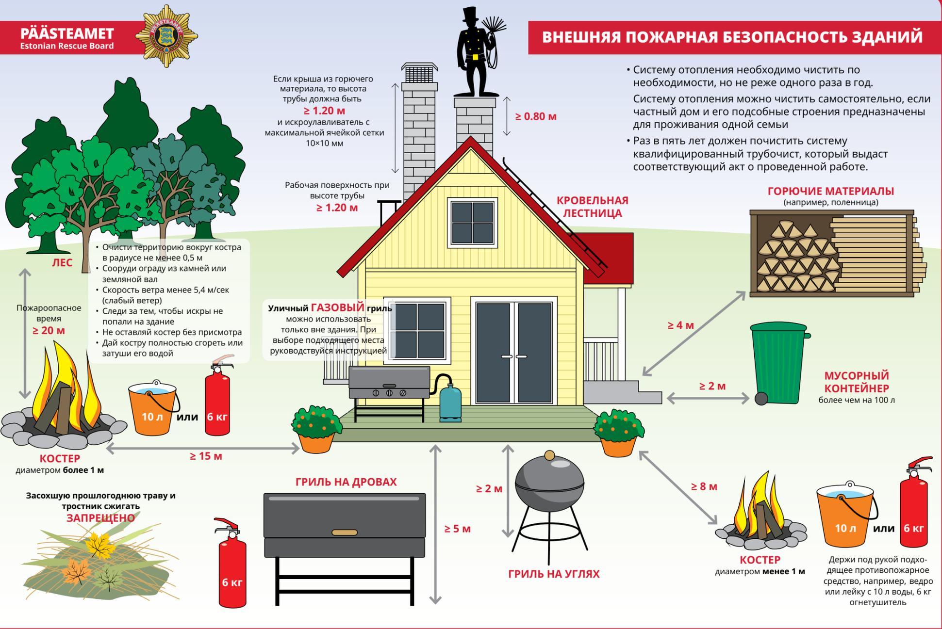
Если крыша из горючего материала, то высота трубы должна быть  $\geq 1.20$  м и искроулавливатель с максимальной ячейкой сетки 10x10 мм
